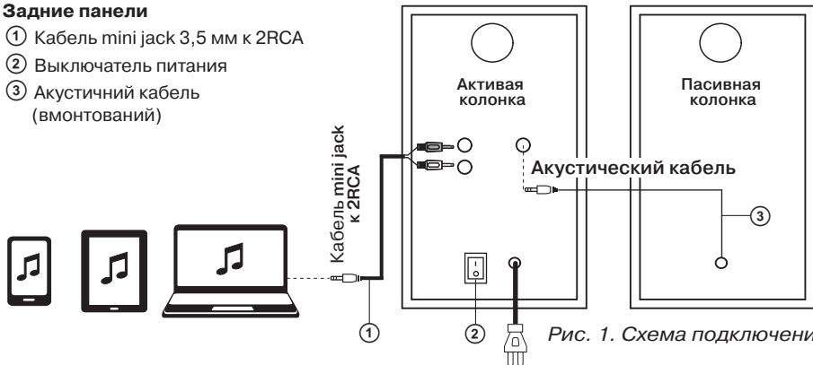
Рис. 1. Схема подключения
